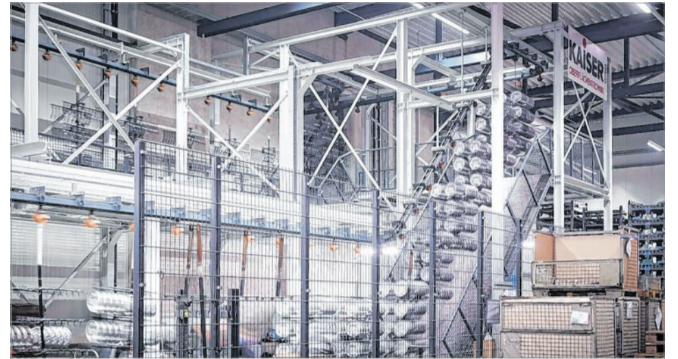
Die moderne Anlage für die Kathodische Tauchlackierung (KTL) verläuft auf 340 Metern. Bauteile brauchen rund zweieinhalb Stunden von der Ein- bis zur Ausfahrt.
