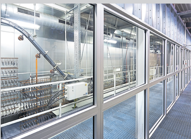
In diesem Bereich findet der Prozess der KTL-Beschichtung statt. (Foto: Kaiser GmbH)
